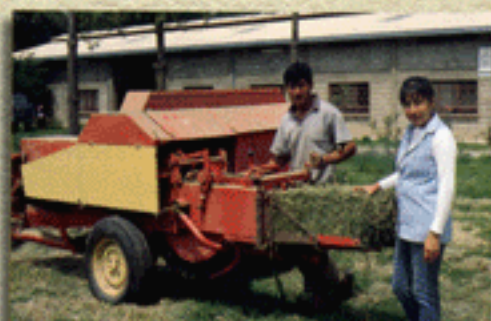
Una forma de hacer heno es cortando la alfalfa y presecando al sol (2 días) y luego empacando con máquina enfardeladora, o en su defecto utilizando caballetes rústicos de madera.
